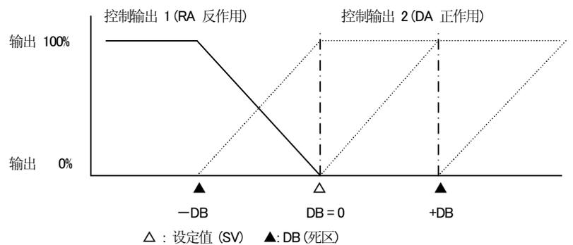
2) OUT 1 RA (加热) · OUT 2 RA (制冷)
