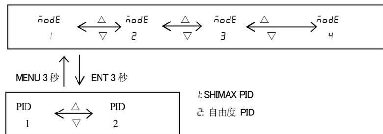
在 Mode 1 至 Mode 9 的顶层窗口,按 (ENT) 键 3 秒,转到选择 SHIMAX PID 或 自由度 PID 窗口。
