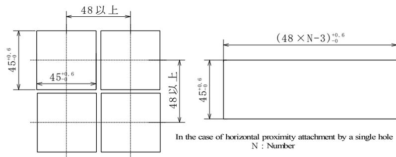
注: 仅能在水平方向的一个开口内紧凑安装。
