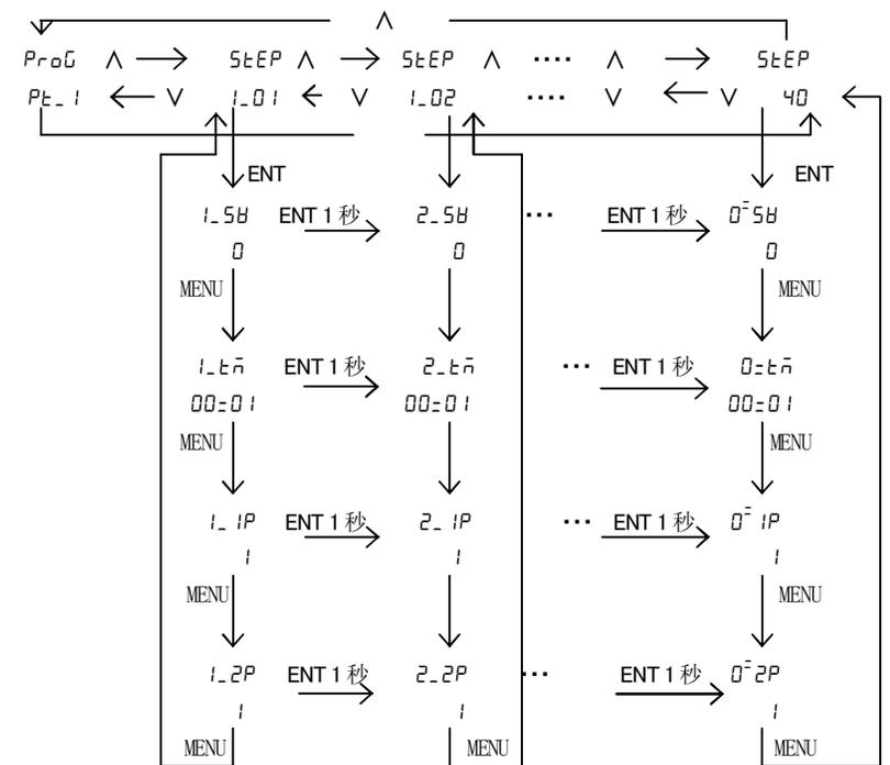
在步设置窗口中, 在数字后面的符号,  $\bar{\quad}$ 代表步 1~9,  $\bar{\quad}$ 代表步 10~ 19,  $\bar{\quad}$ 代表步 20~ 29,  $\bar{\quad}$ 代表步 30 ~39,  $\bar{\quad}$ 代表步 40。
