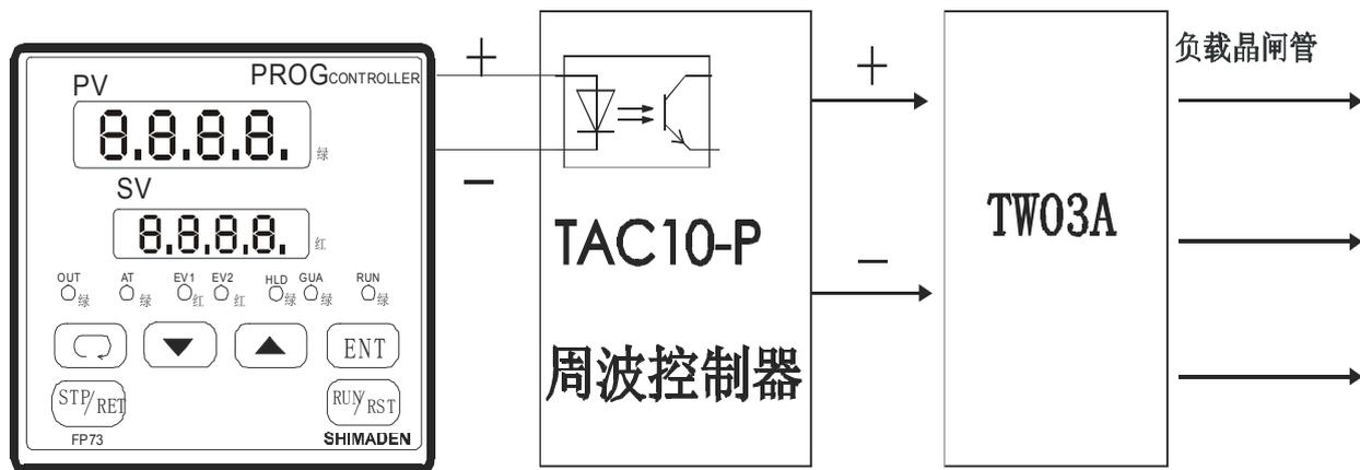
**附注. 周波过零简介:** 工业电加热系统中最具广泛应用的 SSR 信号处理控制器, 它能接受 PWM 或 4-20mA 输入, 产生周期过零式 (PWM 占空比控制) 和周波过零式 (CYC 变周期) 两种输出, 直接驱动 SSR 功率扩展板。具有硬手操和辅助功率调整功能, 先进的周波过零的输出, 由于负载电流的通断是按正弦波均匀分布, 多台设备运行的随机性和叠加性, 所造成的总 力负载电流相对是均衡的, 它提高了调节精度和电源利用效率以及避免了打表针和电力设备增容, 节电效果十分明显。
